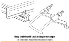
Ahşap kırıkların çelik kısıklara bağlanması sağlar. For connecting wooden beams to steel walers.
