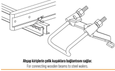
Ahşap kirişlerin çelik kuşaklara bağlantısını sağlar. For connecting wooden beams to steel belts.
